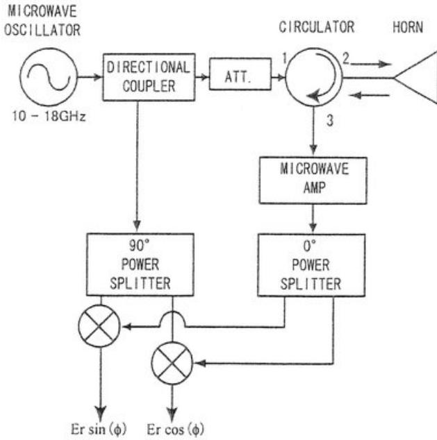
図1. マイクロ波反射法を用いた心拍信号検出装置.
